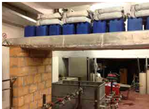
Prova di carico sistema X Plaster sino a 300 kg/m 2 .
